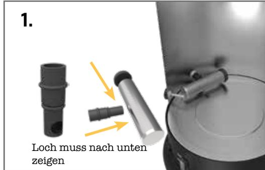
Zur Installation des Filters (14) führen Sie das Silikonrohr in das nach unten zeigende Filterloch. Führen Sie das Rohr soweit ein, dass der Filter in der Rille des Silikons sitzt. Stülpen Sie das runde Silikonende auf die offene Seite des Filters. Installieren Sie jetzt den Filter am Kessel, indem Sie das Silikonrohr über den Filtereingang stülpen (13).
