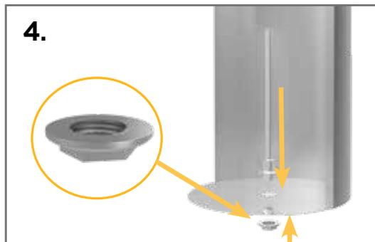
Entfernen Sie die Überlaufmutter (43) vom unteren Überlaufrohr (40). Platzieren Sie das untere Überlaufrohr in dem Loch im unteren Lochblech (42). Fixieren Sie das Rohr, indem Sie die Mutter fest anziehen.
