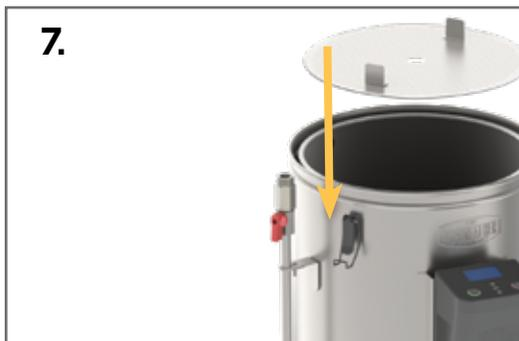
Legen Sie das obere Lochblech (38) in den Innenkorb bis es die Getreidemasse erreicht, drücken Sie das Getreide nicht zusammen, sondern legen Sie das Blech locker drauf. Stellen Sie sicher, dass das Blech eben ist und während des Vorgangs nicht kippt. ACHTUNG: Befeuchten Sie das Innere des Korbes, damit die Dichtung nicht hängen bleibt.
