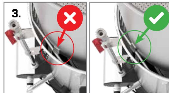
Lassen Sie die Maische in den Kessel laufen und drücken Sie sanft das obere Lochblech (38) herunter, bis es auf dem Getreide ruht (ACHTUNG: Die Oberfläche kann leicht erhitzt sein). Gießen Sie das Läuterwasser langsam und gleichmäßig über das Getreide. Halten Sie das Wasserlevel etwa 10 mm (0.4") über dem Blech, damit es gleichmäßig bleibt. ACHTUNG: Entsorgen Sie das benutzte Getreide entsprechend, z.B. als Kompost oder Hühnerfutter.
