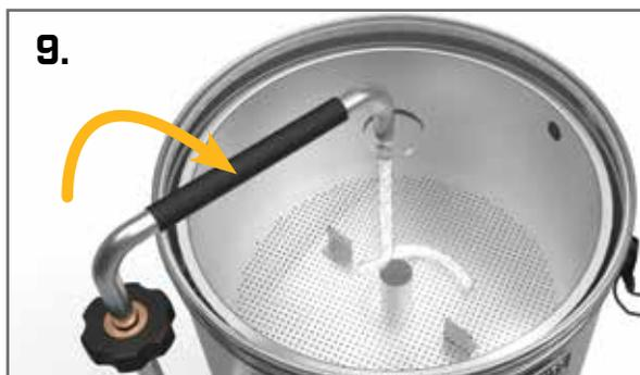
Platzieren Sie den Hartglasdeckel (27) auf den Kessel. Schrauben Sie das Rückführungsrohr (25) an das Ablaufrohr (17) und stellen Sie sicher, dass es richtig verbunden ist. Der Silikonschlauch (26) wird durch das Loch im Glasdeckel geführt und liegt auf dem oberen Lochblech auf (38). ACHTUNG: Die Klammern sollen nicht am Deckel befestigt werden. Sie sind nur notwendig wenn Sie den Aufsatz zur Destillation verwenden.
