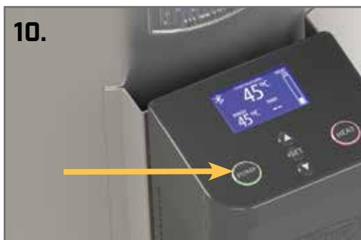
Schalten Sie die Pumpe an. Die Würze aus dem Rückführungsrohr wird auf das obere Lochblech gepumpt.
