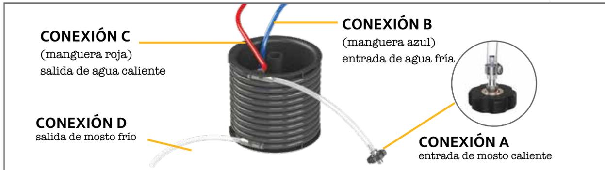
Su enfriador de mosto de contraflujo vendrá con 4 mangueras ya conectadas a las conexiones A, B, C y D. NOTA: el agua fría del grifo fluye en una dirección y el mosto caliente fluye hacia el otro lado.
