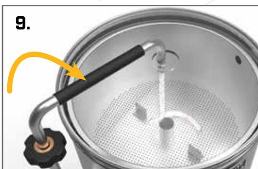
Coloque la tapa de vidrio templado (27) en la caldera. Atornille el tubo de recirculación (25) en el tubo de descarga (17). Asegúrese de que esté introducido correctamente. La manguera de silicona (26) debe atravesar el orificio de la tapa de vidrio y apoyarse en la placa perforada superior (38). NOTA: no se deben utilizar los clips para asegurar la tapa, solo para usar el accesorio de destilación.
