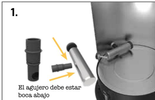
Para instalar el filtro (14) inserte el tubo de silicona en el orificio del filtro, con el orificio en el tubo hacia abajo. Introdúzcalo para que el filtro quede en la ranura del tubo de silicona. Coloque el tapón de silicona redondo en el lado abierto del filtro. Ahora instale el filtro en la caldera empujando el tubo de silicona sobre la entrada del filtro (13).
