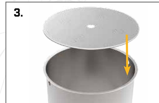
Empuje la placa perforada inferior (42) completamente dentro del cesto interior (34). Empuje hacia abajo los lados para asegurar que esté nivelado. NOTA: debe ser firme al empujar hacia abajo, está diseñado para ajustarse bien. Humedezca el interior del contenedor de granos o aplique algo de polvo de grano alrededor para que la junta de silicona no se pegue y sea más fácil de insertar.
