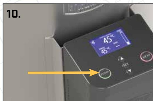
Enciende la bomba. El mosto que fluye a través de la tubería de recirculación debe llenarse en la parte superior de la placa perforada superior.
