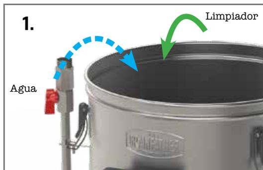
Vacía la cabezuela inclinando hacia abajo en un desagüe. Retire el filtro de la bomba y enjuague, vuelva a colocarlo después del enjuague. Llene la caldera con agua y limpiador, según las instrucciones del limpiador.
