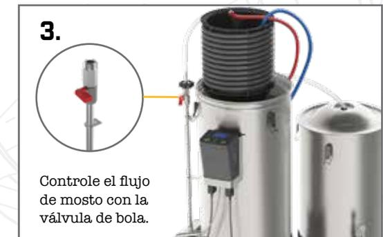
Encienda el agua de refrigeración. Una vez que la conexión D se enfríe, apague la bomba y colóquela dentro del fermentador limpio y esterilizado. Trate siempre de mantener el fermentador sellado. Añada levadura como se indica en la receta. Haga una lectura de gravedad original (OG por sus siglas en inglés) de mosto frío.
