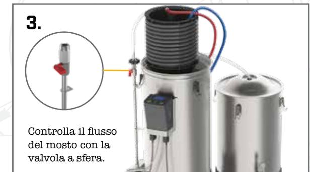
Apri il rubinetto dell'acqua. Una volta che il tubo 'uscita mosto freddo' si sarà raffreddato, spegni la pompa e trasferisci il mosto nel fermentatore pulito e sterilizzato. Cerca di tenere il fermentatore costantemente sigillato. Aggiungi il lievito come indicato nella ricetta. Fai una lettura OG del mosto freddo.
