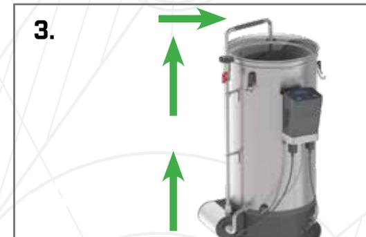
Dopo 5 minuti rimuovi il raffreddatore e collega il tubo di ricircolo (25). Fai circolare il detersivo per altri 10 minuti.
