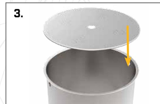
3. Spingi la piastra filtrante inferiore (42) fino al fondo del cestello interno (34). Fai pressione sui lati per assicurarti che sia livellato. NOTA: dovrai spingere con forza, è stato progettato per incastrarsi saldamente. Inumidisci l'interno del cestello o passaci intorno della polvere di cereali in modo che non si attacchia alla guarnizione in silicone e sia più facile da inserire.
