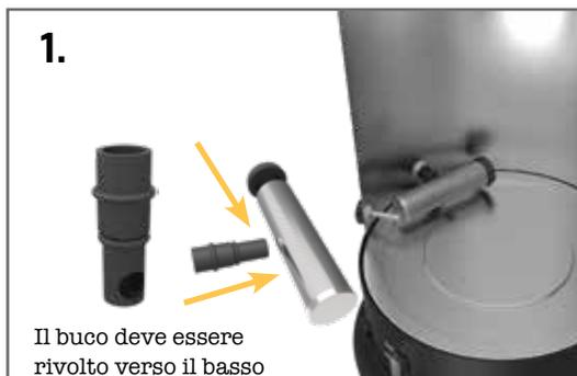
1. Il buco deve essere rivolto verso il basso. Per installare il filtro (14) inserire il tubo in silicone nel buco del filtro, con il buco rivolto verso il basso. Spingilo in dentro fino a che si incastrerà nella scanalatura nel tubo in silicone. Spingi il pezzo circolare in silicone sulla parte aperta del filtro. Adesso installa il filtro nel bollitore spingendo il tubo di silicone nell'ingresso del filtro (13).
